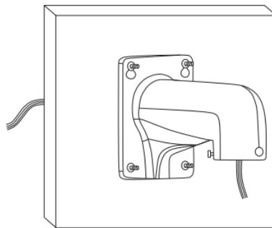
4. Закрепите скоростную поворотную камеру на кронштейне с помощью фиксировочных винтов.
